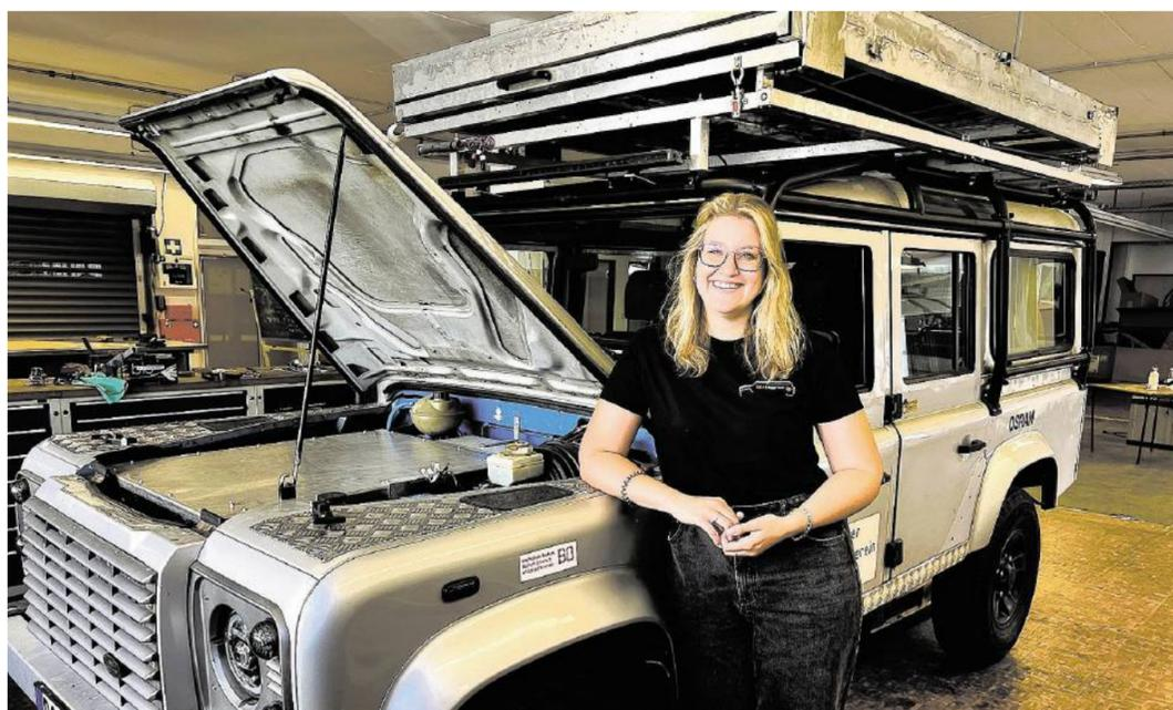
Studentin Xenia Wiedenmannott aus Haltern präsentiert den zum Solar- und E-Auto umgebauten Land Rover. Unter der Motorhaube sieht man die Batteriekiste, auf dem Dach des Wagens befindet sich die Schublade, in der sich ausklappbare Solarmodule befinden.
