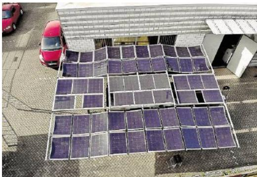
So sieht die Solarmodul-Konstruktion von oben aus, wenn sie komplett ausgeklappt ist. Der Land Rover ist kaum noch zu erkennen, das umgebaute Solarauto steht in der Mitte unter den Modulen.
